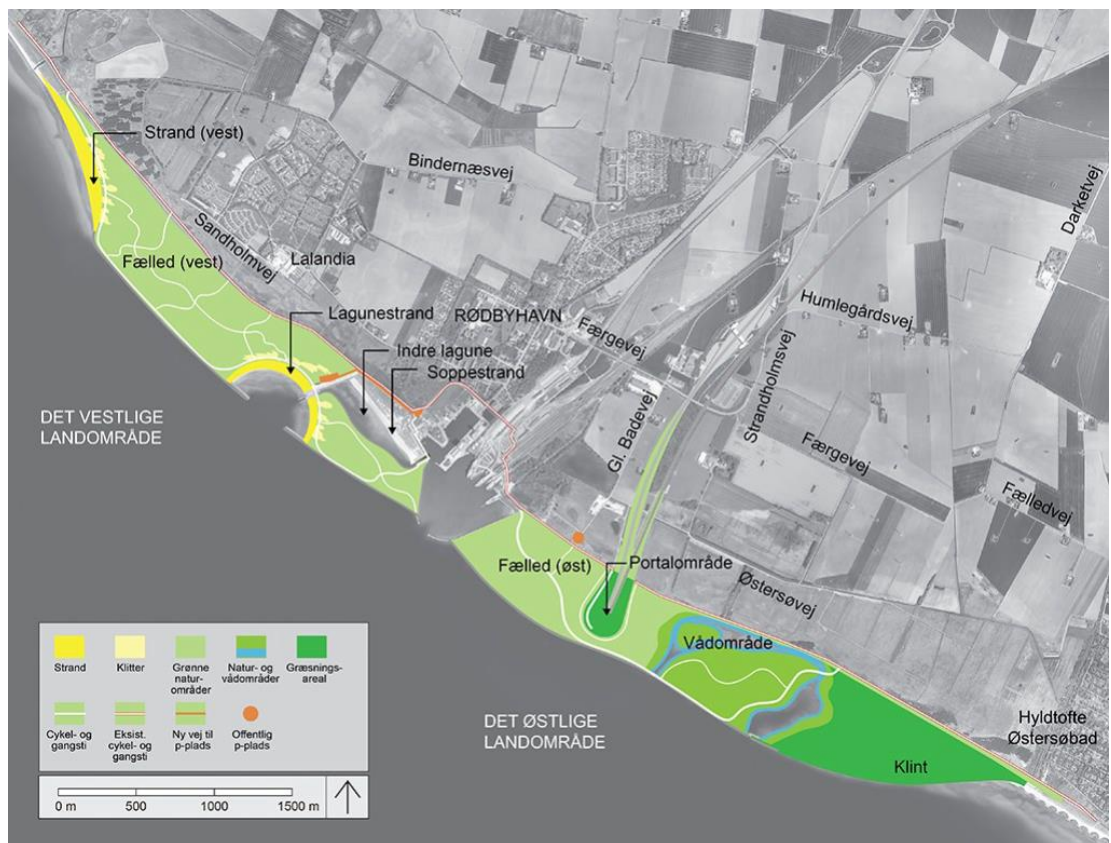
Figur 2.2 Principskitse for det nye landindvindingsområde (fra den oprindelige VVM-redegørelse for den faste forbindelse over Femern Bælt, Femern 2013). Som det fremgår af skitsen, etableres et vådområde på det tidligere havneområde til fabrikken samt en klint med afgræsning øst for vådområdet.
