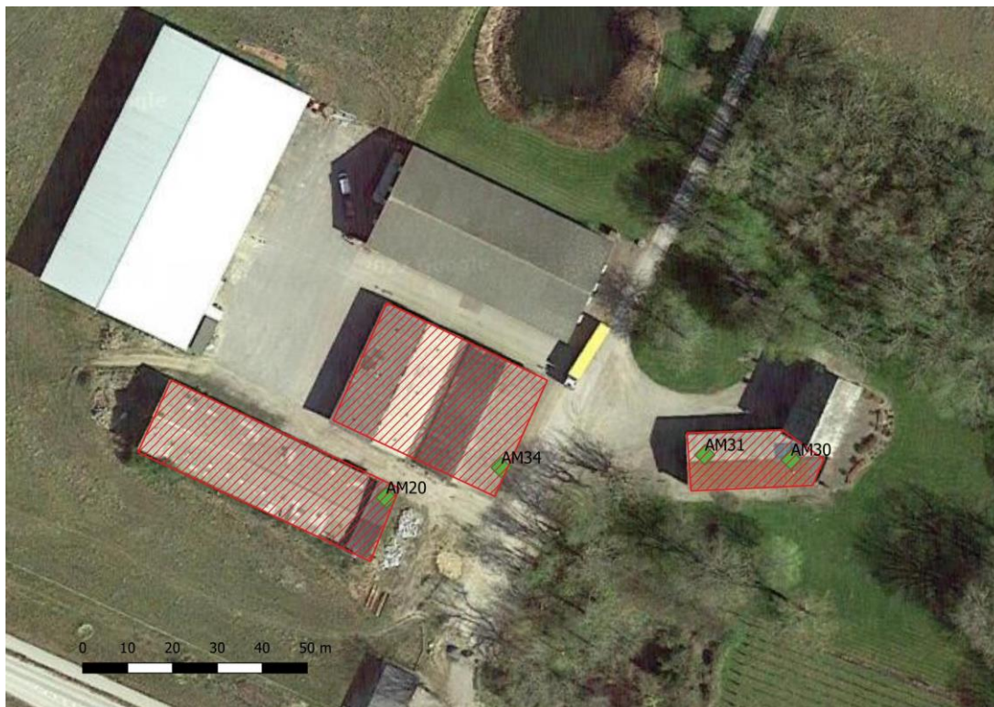
Figur 4 Bygninger, som foreslås nedrevet (rød skravering), samt placering af lyttebokse i oktober 2022 (grønne romber).
