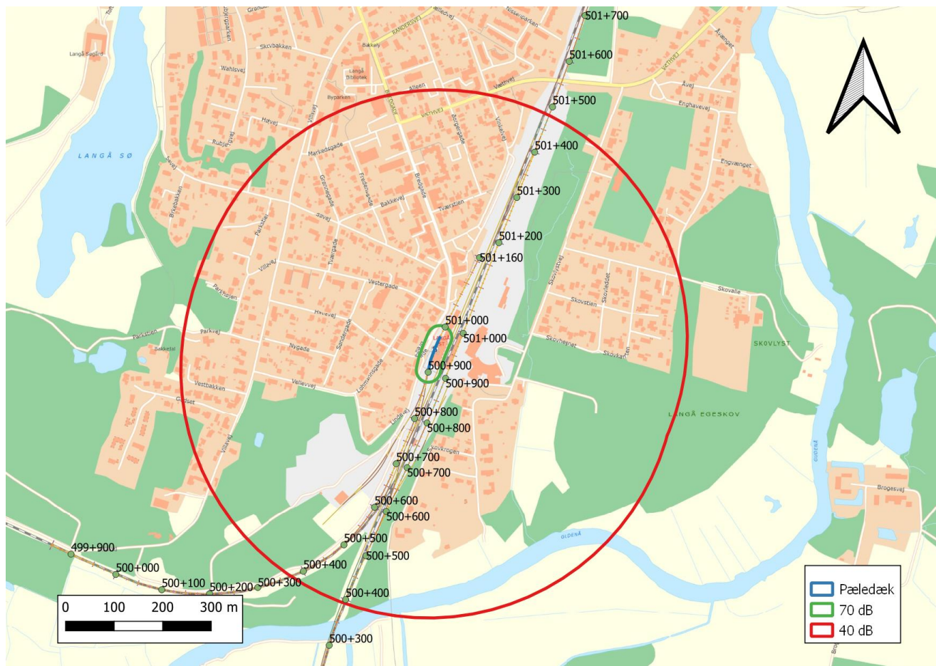
Figur 3.7: Grænseværdiafstande på Lr 40 dB(A) og Lr 70 dB(A) i forbindelse med etablering af pæledæk ved Langå Station
