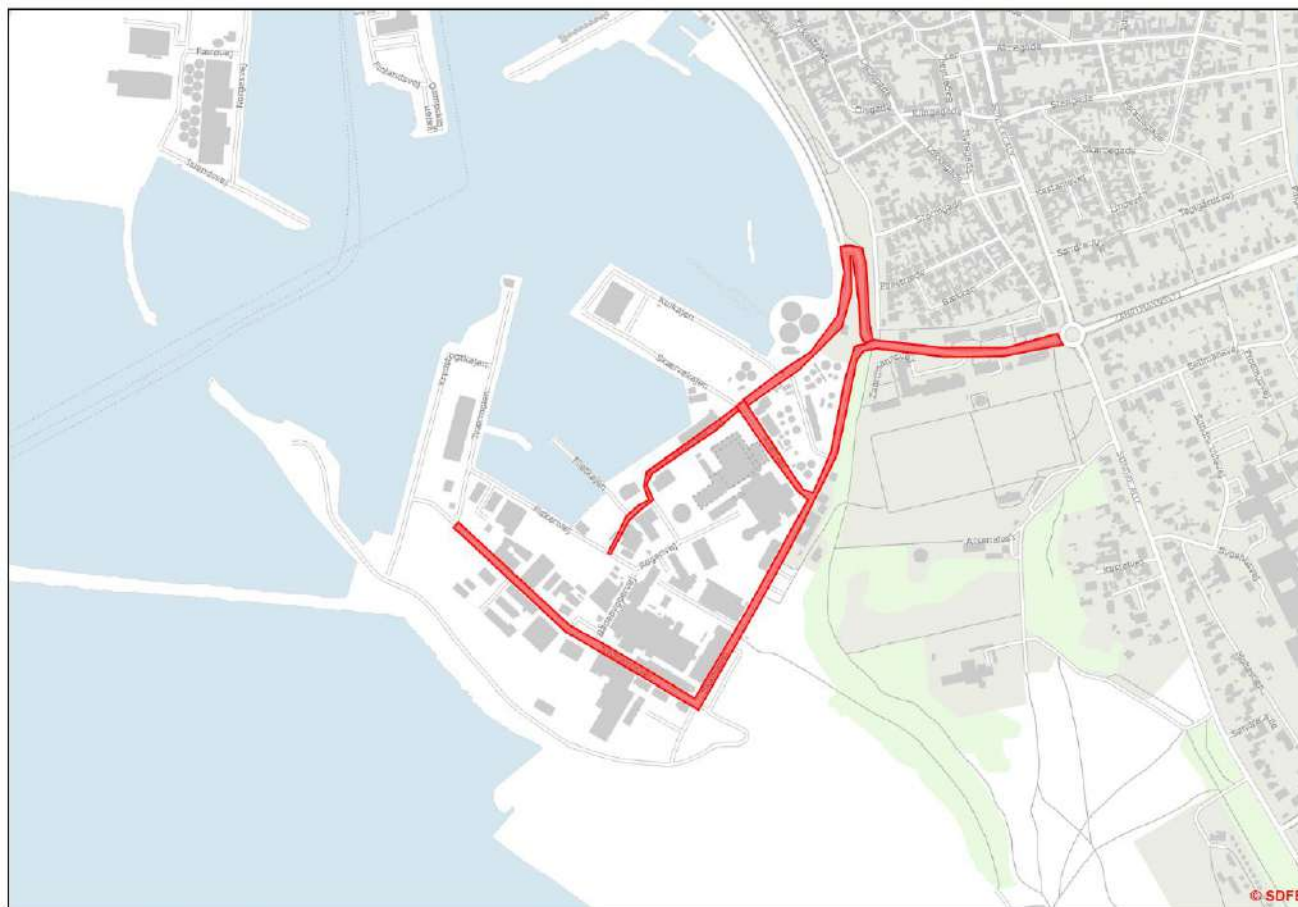
Figur 5.2 Angivelse af vejstrækninger (rød markering), hvor eksisterende vejbrønde skal fejles og renses 2 gange ugentligt under udførelsen.
