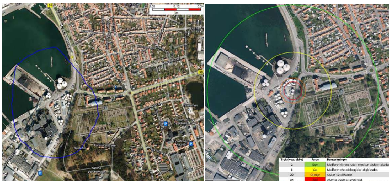
Figur 14.5 Foreningskurver for mulige konsekvensafstande for eksplosion for hhv. Uno-X (venstre) og Q8 (højre). Den blå linje på venstre figur angiver grænsen for en påvirkning med et eksplosionstryk på op til 5kPa ved en sandsynlighed 10^{-9} pr. år – dette svarer til den gule linje i højre figur.
