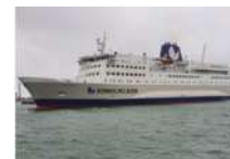
Povl Anker Erstatningsfærge 262 personbilsenheder 1.500 passagerer Bygget 1978
