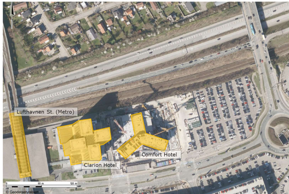
Figur 4-4 Oversigt over konstruktioner, hvor der i anlægsfasen kan forekomme overskridelser af de vejledende grænseværdier for acceptabel vibrationskomfort jf. Orientering fra Miljøstyrelsen. Gul markering indikerer konstruktioner, der ligger inden for kritisk afstand til spunsningen.
