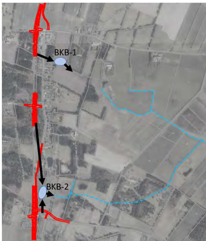
Figur 4.9 Mulig placering af regnvandsbassiner ved Tved
