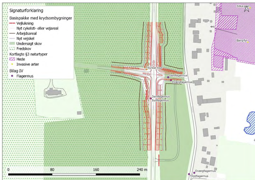
Figur 16.8 Kanaliseringer og busstoppesteder ved Tved (st. 10.3-11.6). krydset mellem Hanstholmvej og Hanstholmvej til Tved Kirke.
