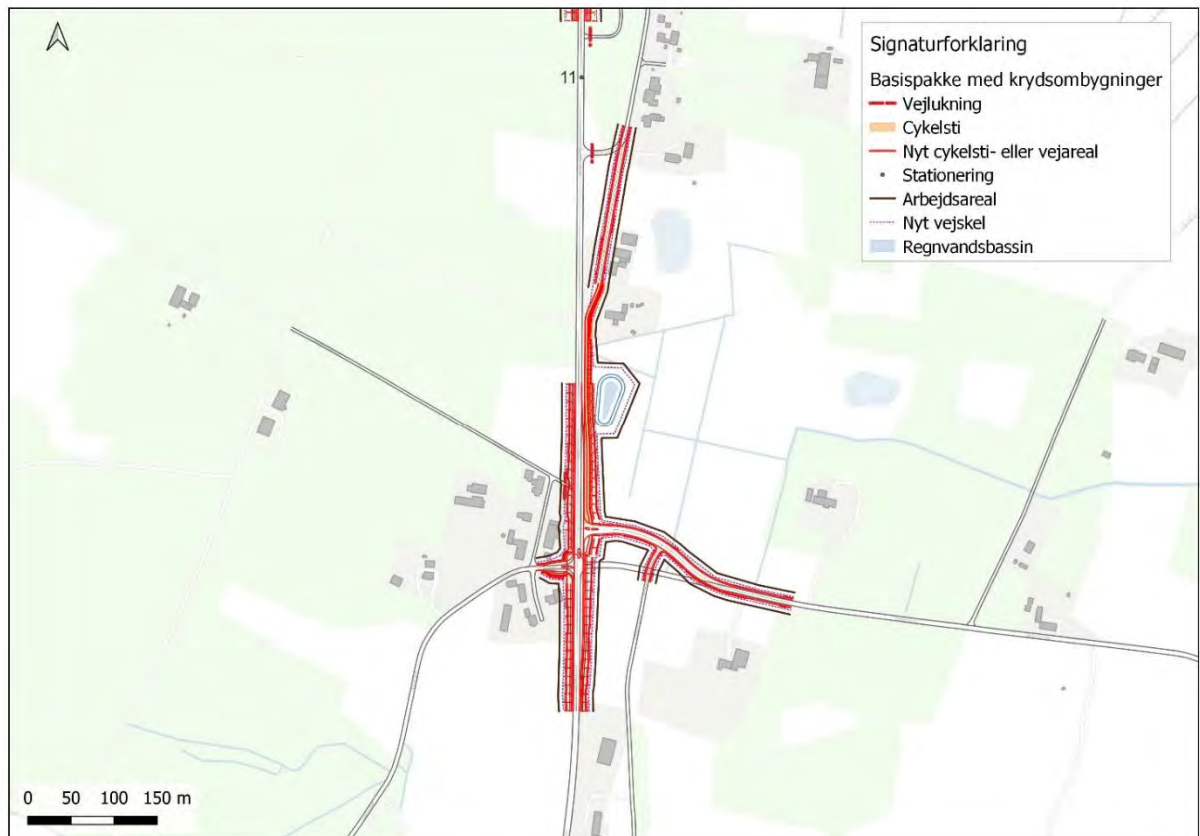
Figur 8.32 – Kanaliseret kryds ved Forlagt Ballerumvej og Vorringvej.
