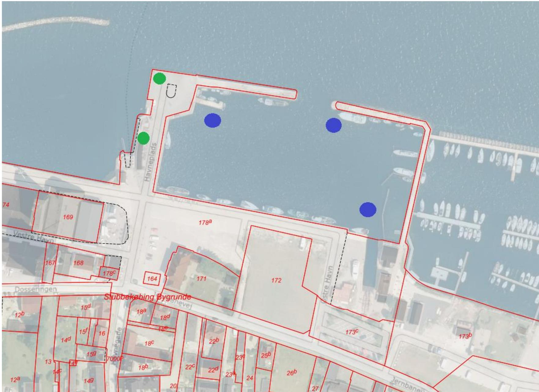
Geotekniske borer på vand (3 stk.) er angivet med blå cirkler
