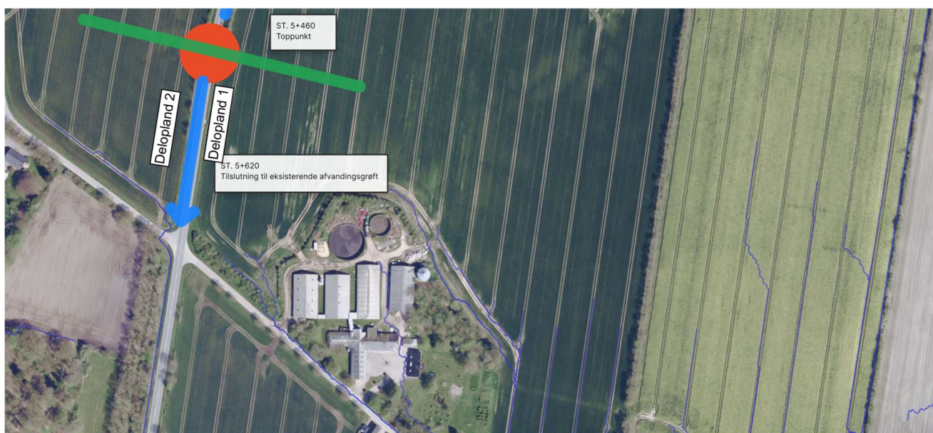
Figur 4.7. Afvandingsstrækning fra st. 5.460 til st. 5.620. Pilen indikerer hvor der i dag og fremadrettet vil være afløb til vandløbet. Derudover ses beskyttet natur eng (grøn) og overdrev (gul).
