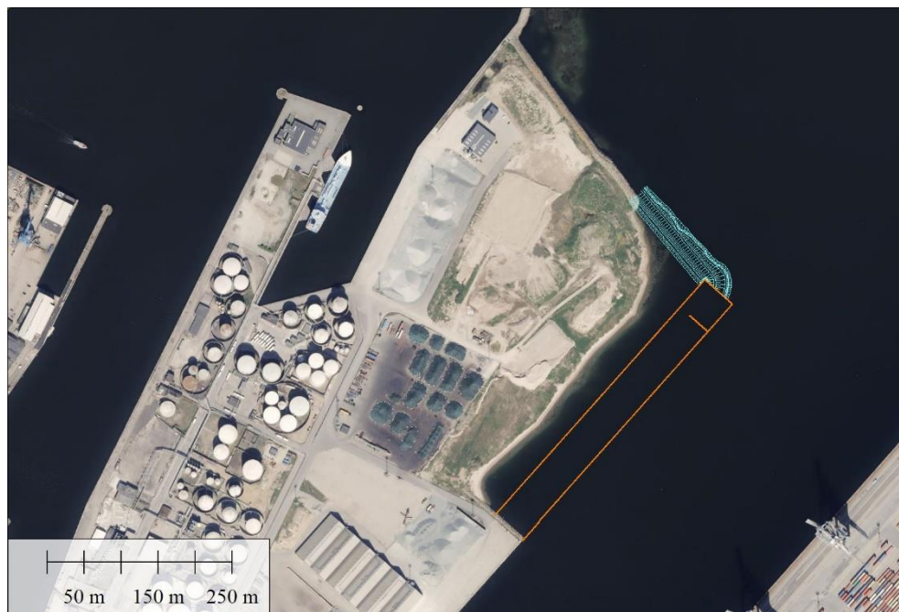
Figur 4-4 Skitseprojekt foretape 2 af Omnikajen. Plan for kajvæg, stenkastning og opfyldning. Orange: Omnikajen etape 2. Blå: ny stenkastning.
