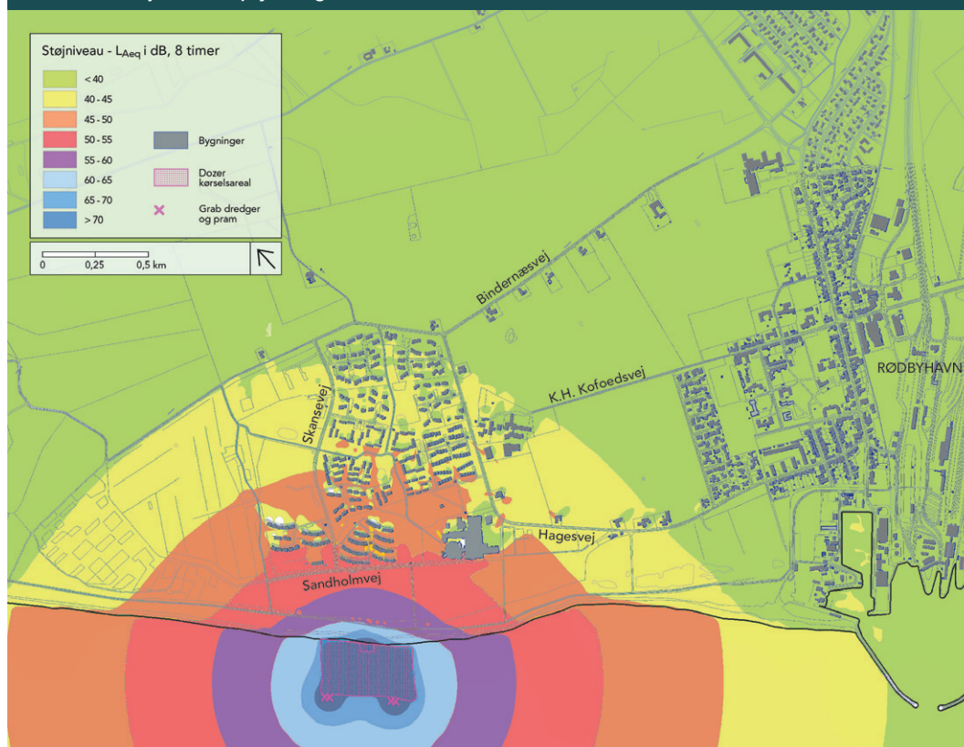
FIGUR 5 Støj fra landopfyldning ud for Lalandia
